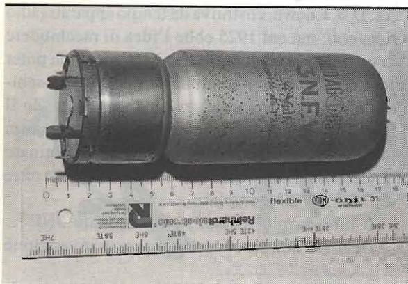
figura 3 - Il tubo 3NFW contenente tre triodi.
