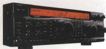
FT 920: La "Base Station" ad alta sensibilità, con ottime caratteristiche di intermodulazione, DSP, accordatore d'antenna incorporato alta tecnologia sia in onde corte sia nella "magic band" a 50 MHz, con 100 W d'uscita in HF. Registratore vocale digitale incorporato per i contesti!
